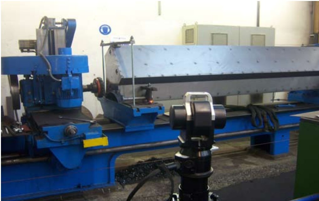
Messen einer Fräsmaschine (Maschinenbett, Spanntisch und Arbeitsbereich des Fräskopfes) mit einem Laser Tracker
